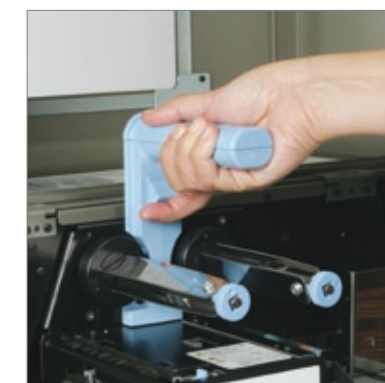
Fácil acceso interno al levantarse verticalmente el bloque de impresión
